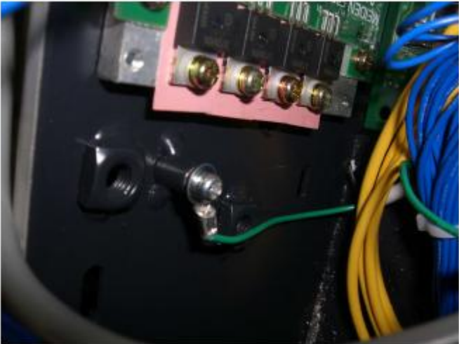
图 14 控制箱内部的底线端子（M3）
