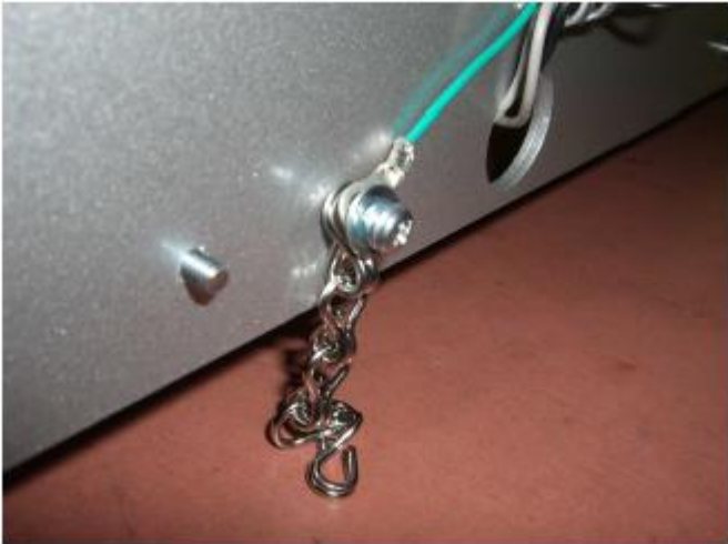
图 15 链条的安装(M5 端子)
